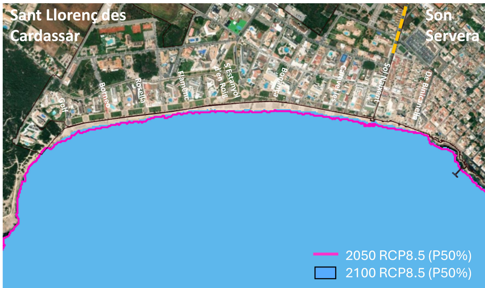
Figura 68. Mapa de inundación permanente para los años horizonte 2050 y 2100 bajo el escenario RCP 8.5 considerando el percentil de aumento del nivel medio del mar del 50%.
